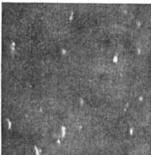
4 a) Ni-niederschlag mit dichten Stellen unter Wasserstoffblasen.
